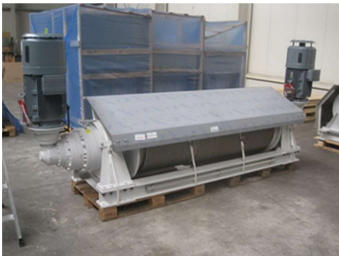
Guincho de içamento da lança com 2 acionamentos e 2 freios. Fator de serviço do freio > 2,0
